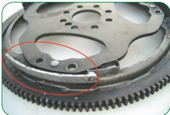
Один из магнитных секторов маховика, разрушенный посторонним предметом, был отремонтирован.
