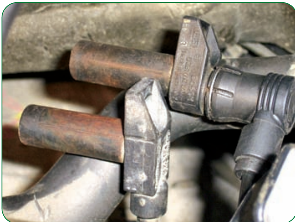
Датчики положения коленвала 104-го двигателя MB старой и новой версии выдают импульсы различной полярности.
