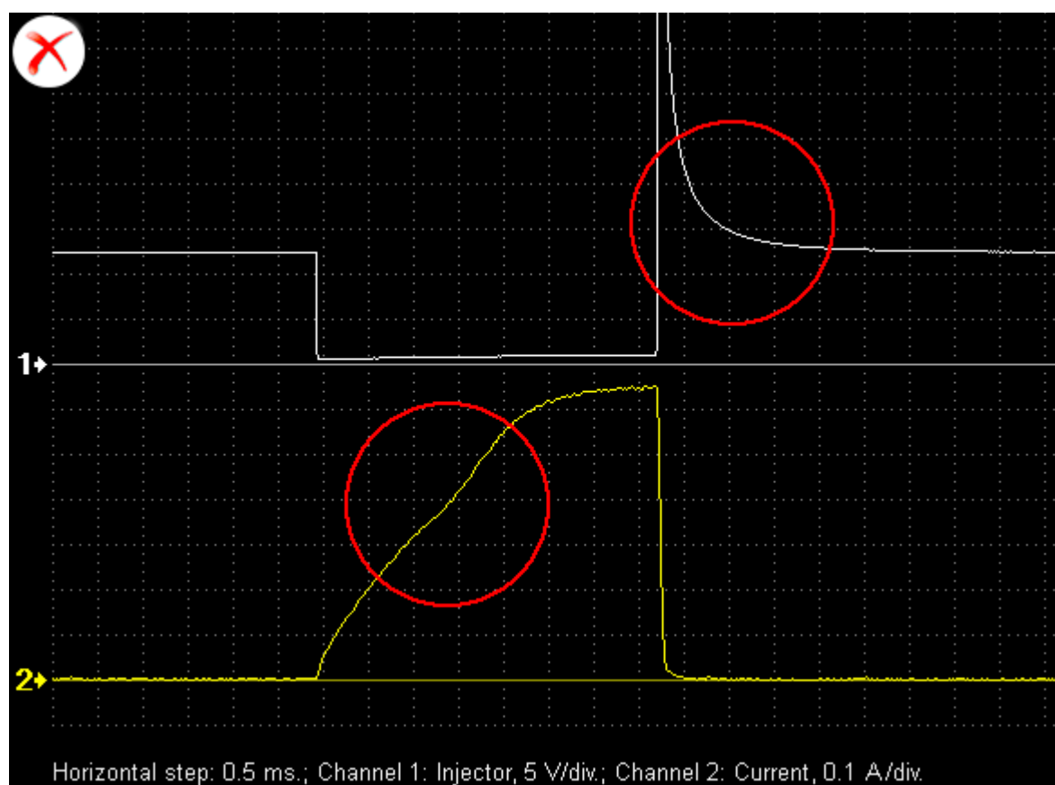
Форма осциллограмм напряжения и тока неисправной форсунки. Игла распылителя форсунки заклинила.
