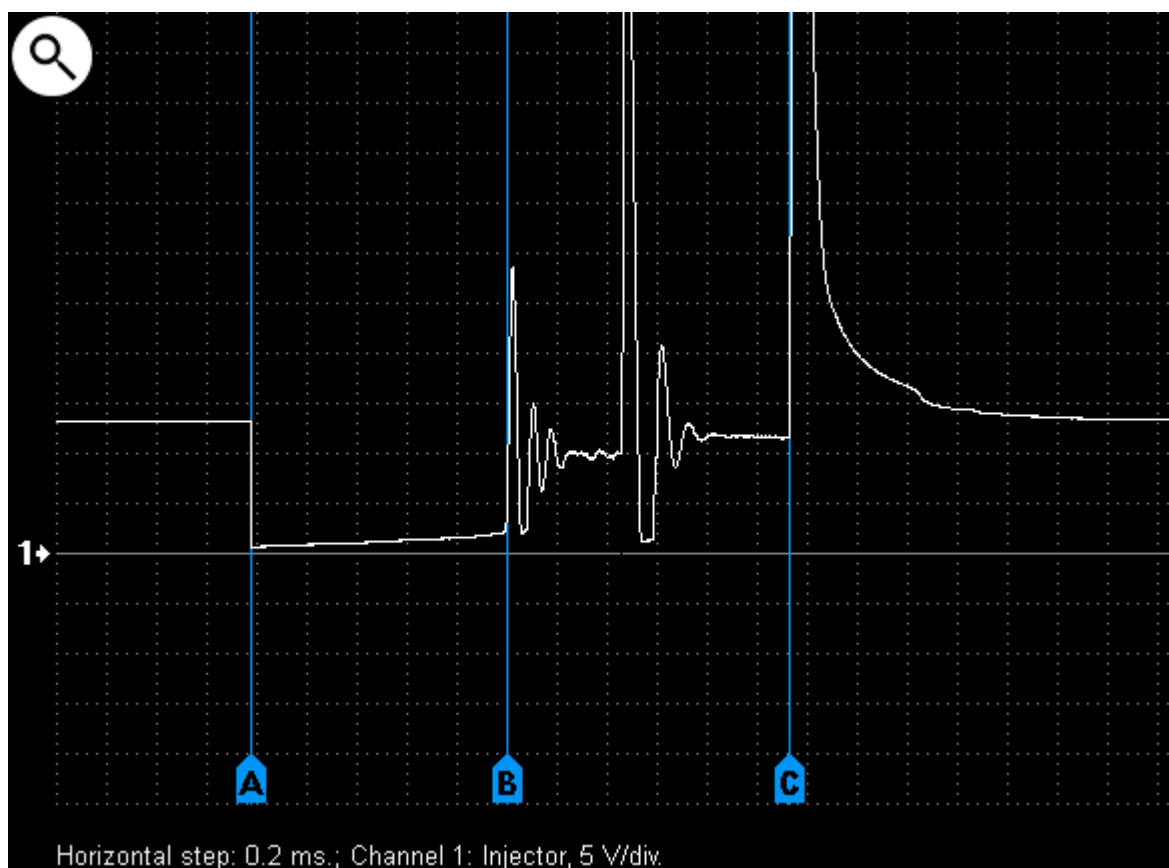
Осциллограмма напряжения на управляющем выводе низкоомной топливной форсунки точечного впрыска Ford (Ford Orion 1.4 1993). A B – фаза подъема иглы форсунки; B C – фаза удержания иглы форсунки.
