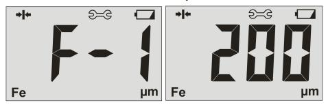
Сделайте замер металлической основы поместив на нее калибровочную пластину. При необходимости повторите измерение.
