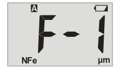
Сделайте замер на той же металлической основе вместе с эталонным покрытием известной толщины. Например 700 или 1000 µm. При необходимости повторите замер. В то время, пока отображается результат измерения коротко нажимая
