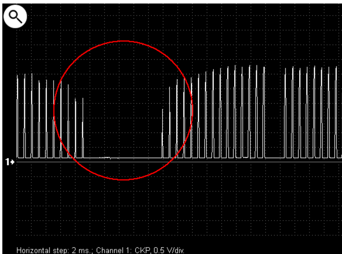
Осциллограмма напряжения выходного сигнала неисправного датчика коленвала на эффекте Холла.
